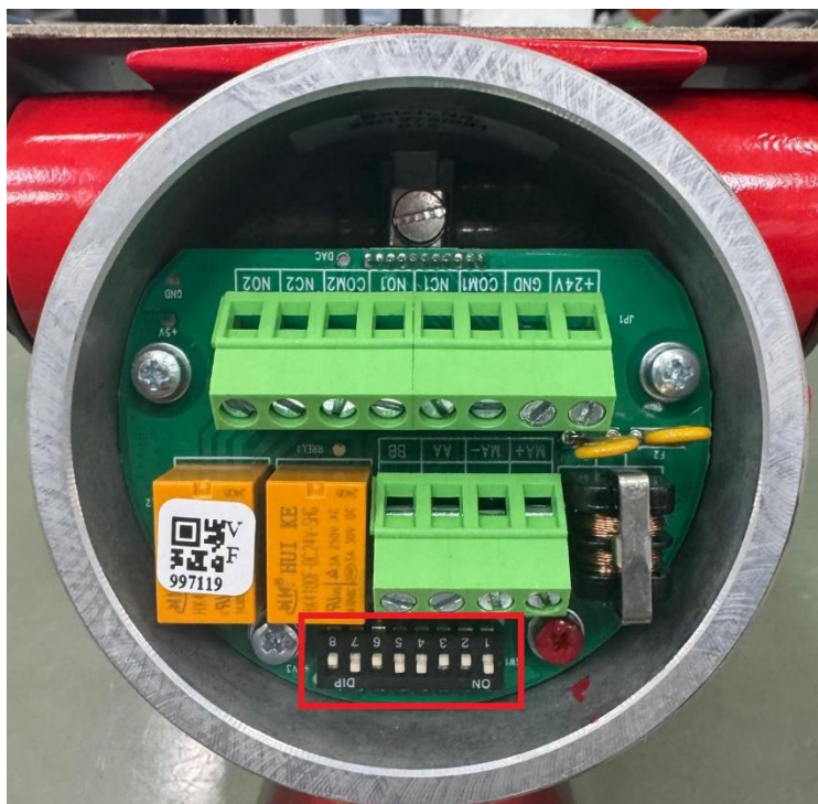
Рисунок В.1 – Переключатели для установки Modbus адреса
